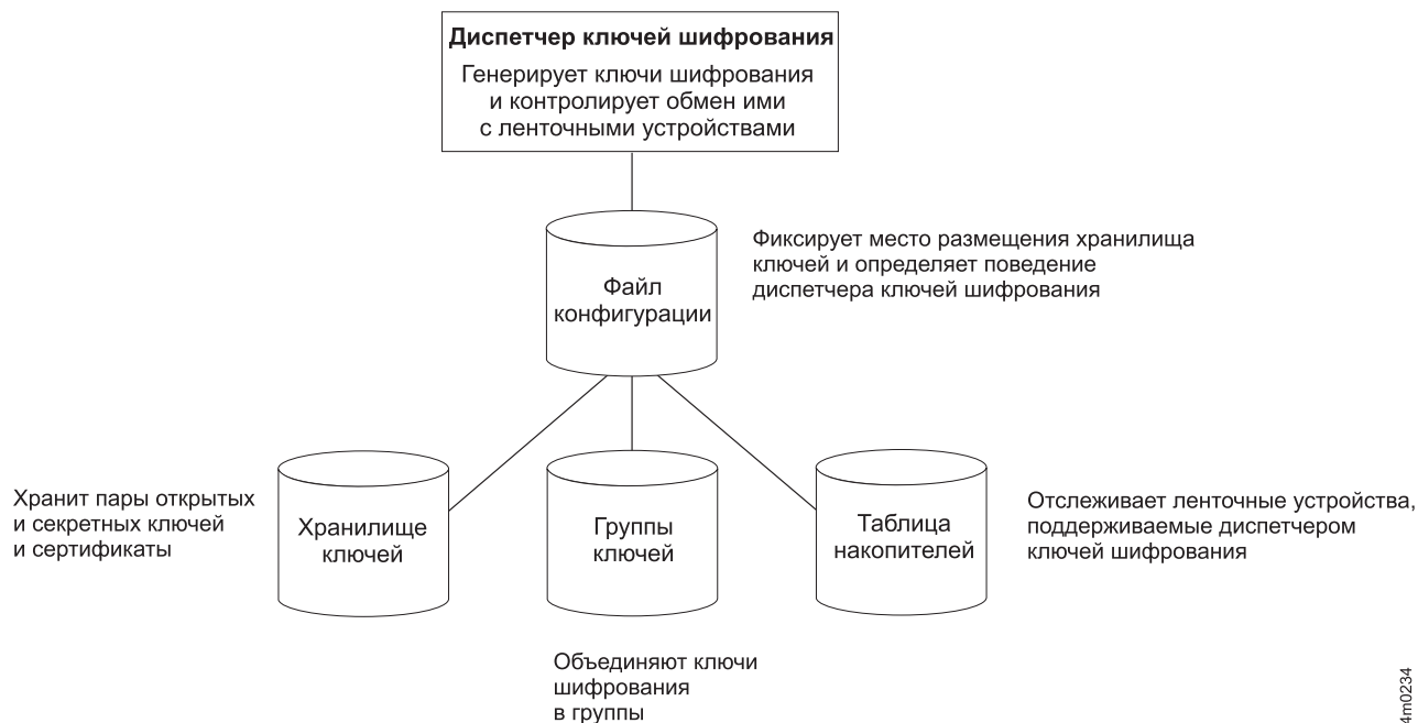
Рисунок 1-1. Четыре основных компонента Encryption Key Manager
